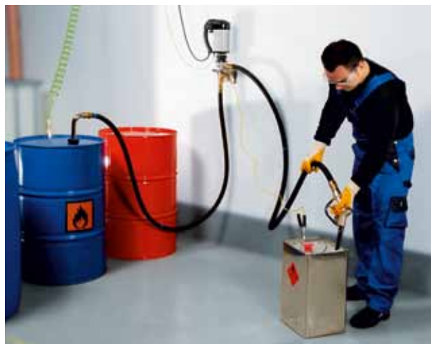
Abfüllung von Lösemittel aus 200-Liter-Fass in unterschiedliche Gebinde.
